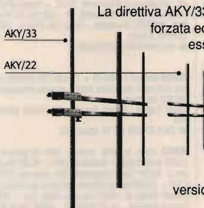
La direttiva AKY/33 è una eccezionale 3 elementi rinforzata ed allargata di banda; applicando ad essa i due elementi AKY/22 si ottiene la prima direttiva in acciaio a 5 elementi completamente a banda larga. Le parti possono essere fornite separatamente in quanto, data la interscambiabilità di esse, i due elementi di prolunga possono essere inseriti in seguito. La 5 elementi viene prodotta anche in versione VHF banda III per trasferimenti radio e TV Broadcasting.
