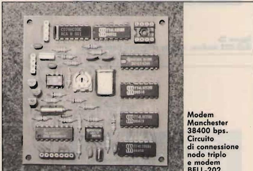
**Modem Manchester 38400 bps. Circuito di connessione nodo triplo e modem BELL-202.**
